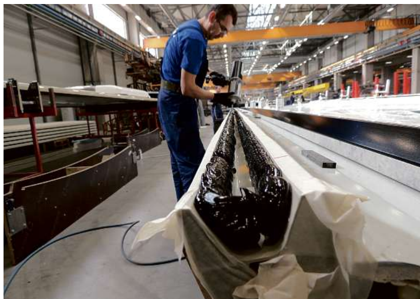
Schnelle Montage: Der Klebstoff wird an der Unterseite eines vormontierten Busdaches aufgebracht. Pressebild
